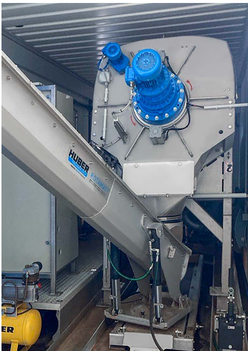
Mietanlage - HUBER Schneckenpresse Q620.2 auf Wechselbrücke
