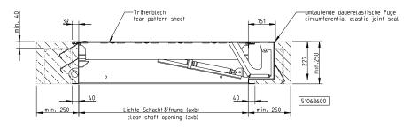
Abb. 1 - SD7 einbetoniert
