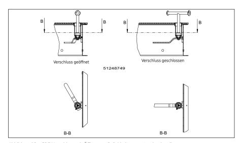
Abbildung 12 – SD7 Verschluss mit Öffnungsmöglichkeit von unten (optional)
