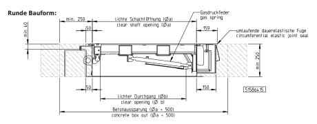
Abb. 2 - SD7.R einbetoniert
