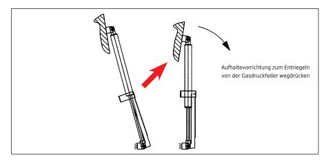
Abbildung 11 – Aufhaltevorrichtung der Gasdruckfeder entriegeln
