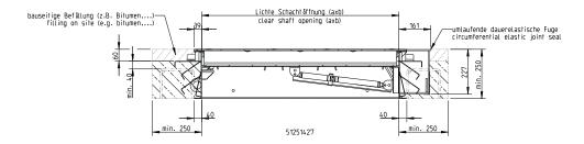
Abb. 4 - Rahmen für alternative Anbindung wie Bitumen, Pflaster, Fliesen o.ä. mit maximal 60mm Stärke.
