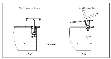
Abbildung 10 - SD7 Verschluss (Abbildung ohne Profilzylinder)
